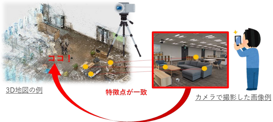
図 画像を用いた測位の仕組み
